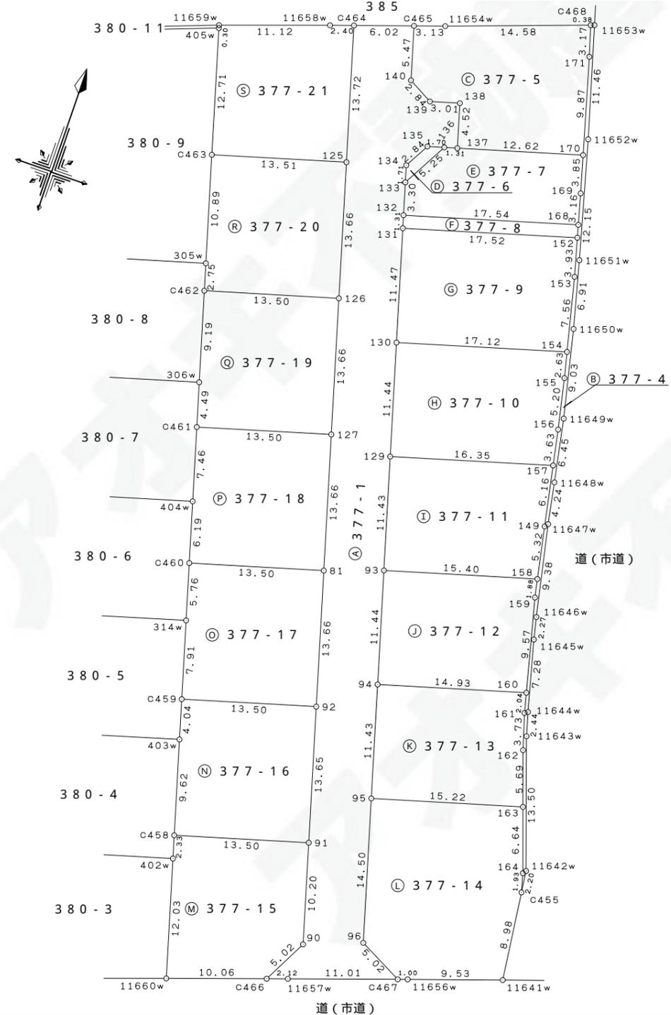
ネットワーク型RTK-GNSS測量に使用された与点の成果 (令和元年10月19日測量)
